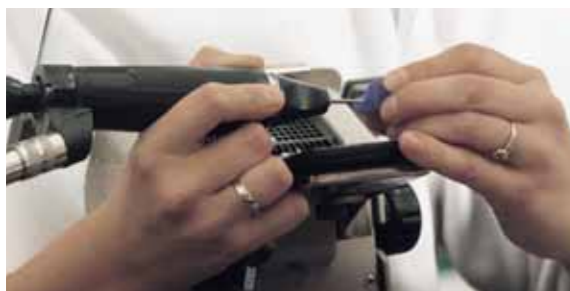
Bohren des Kanals für den Filter
