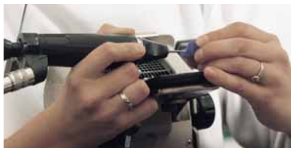
Bohren des Kanals für den Filter
